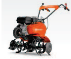
HUSQVARNA TF 435 Motoenxada de alto rendimento com fresas frontais e um motor fiável e fácil de arrancar. Duas marchas para frente e uma para atrás. Guiador regulável para maior flexibilidade. Honda GX160, transmissão por corrente / manual, largura de trabalho 80 cm, profundidade de trabalho ≈ 30 cm. 967 10 12–01
