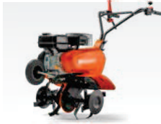
HUSQVARNA TF 225 Motoenxada simples, prática e fácil de manobrar. Motor silencioso e fácil de arrancar. Protetor de plantas e guiador regulável. Motor Rato R 180, transmissão por corrente / manual, largura de trabalho 60 cm, profundidade de trabalho ≈ 25 cm. 967 10 09–01
