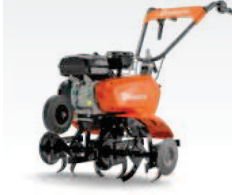
HUSQVARNA TF 335 Motoenxada fácil de manobrar equipada com um potente motor, duas marchas para a frente e uma para trás. Fornece com protetor de plantas e guiador regulável. Briggs & Stratton CR950, transmissão por corrente / manual, largura de trabalho 80 cm, profundidade de trabalho ≈ 30 cm. 967 10 11–01
