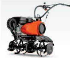
HUSQVARNA TF 536 Motoenxada robusta e potente com fresas frontais. O motor fácil de arrancar é ideal para ambientes secos e poeirentos. Duas marchas para a frente e uma para trás. Honda GX160, corrente / manual, largura de trabalho 90 cm, profundidade de trabalho ≈ 30 cm. 967 63 78–01
